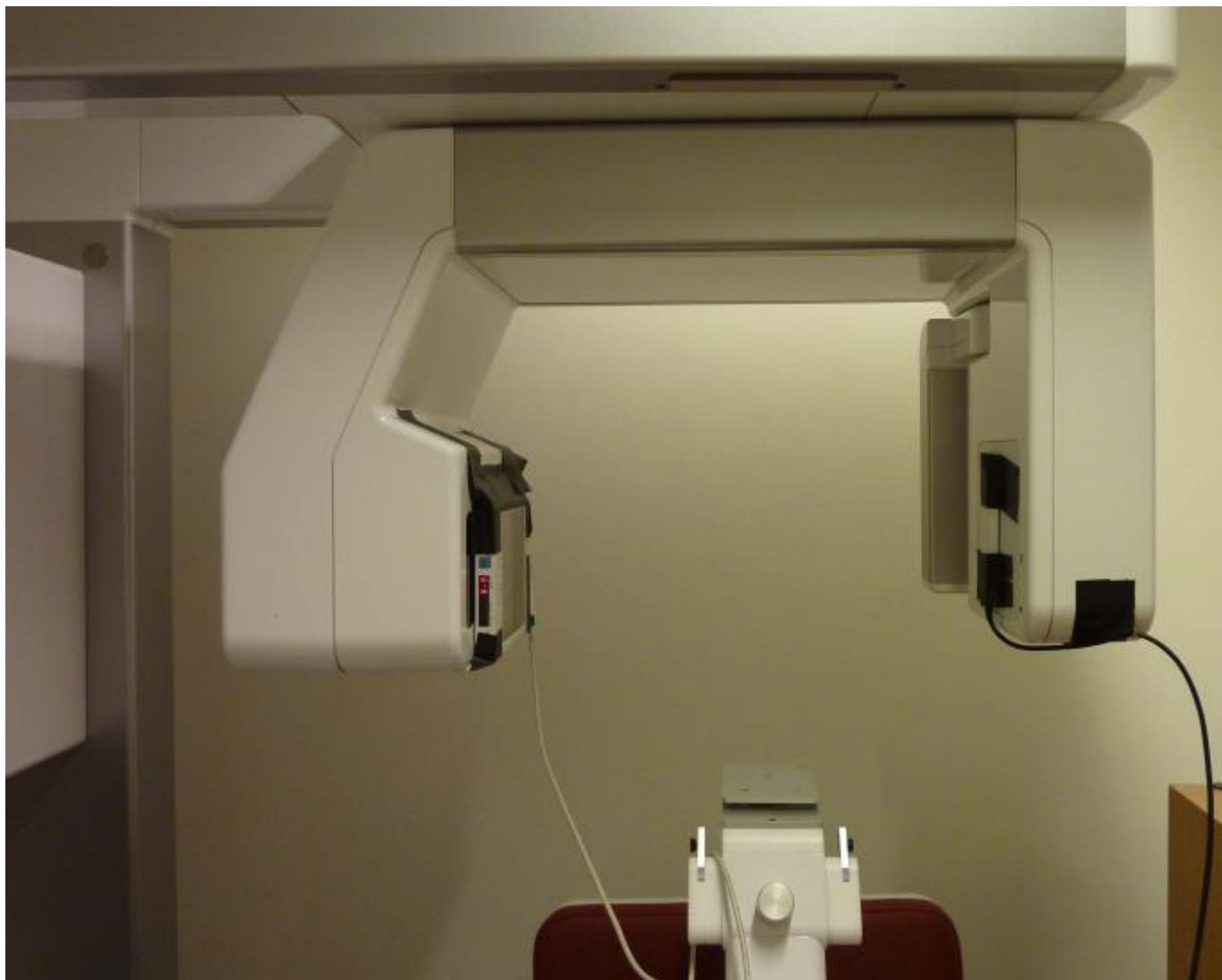
Eksempel på dosemålinger på Scanora 3D (VacuDap DAP-meter og Unfors Xi RC-probe tapet til enheten)
